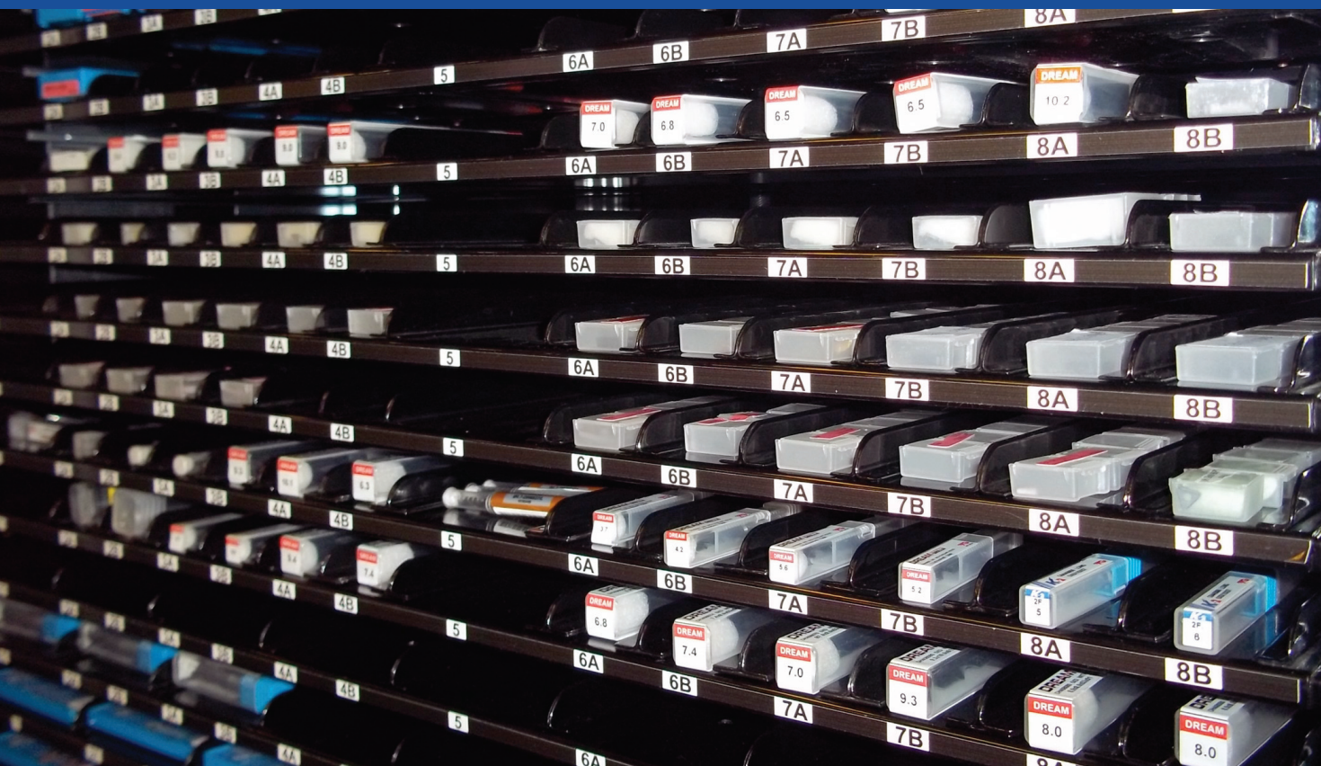
V automatu mohou být uskladněny různé typy nástrojů od VBD po frézovací tělesa.
